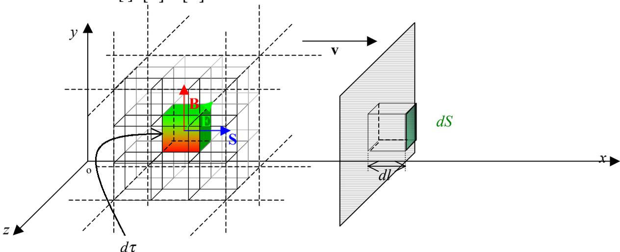
Il vettore di Poynting è un vettore che in ogni punto fornisce con la sua direzione la direzione in cui si propaga l'energia e con il suo modulo l'intensità istantanea, cioè, la potenza istantanea che attraversa una superficie unitaria disposta in direzione perpendicolare al vettore stesso.
