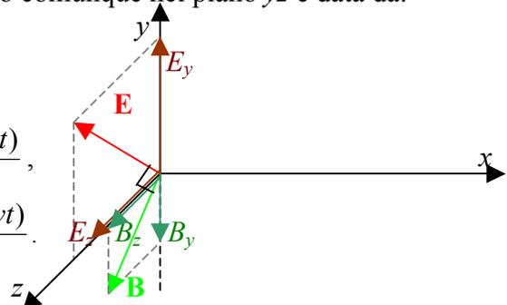
Ciò significa che nel caso generale  $\mathbf{E}$  è un vettore che pur giacendo sempre nel piano  $yz$ , può cambiare direzione secondo i valori istantanei delle componenti. L'onda può sempre decomporre in due onde trasversali polarizzate in piani normali fra loro  $yx$  e  $zx$ . Per ogni onda i campi elettrici e magnetici sono normali fra loro.
